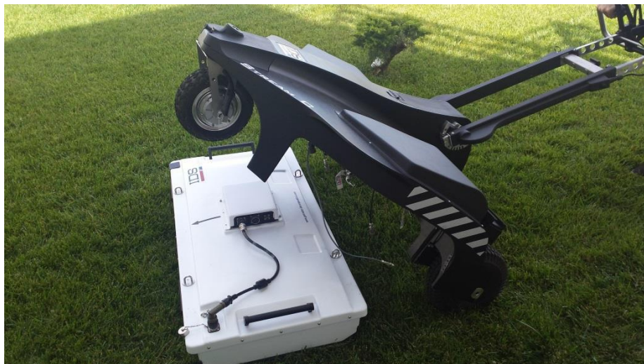
图25-提升框架连接天线
