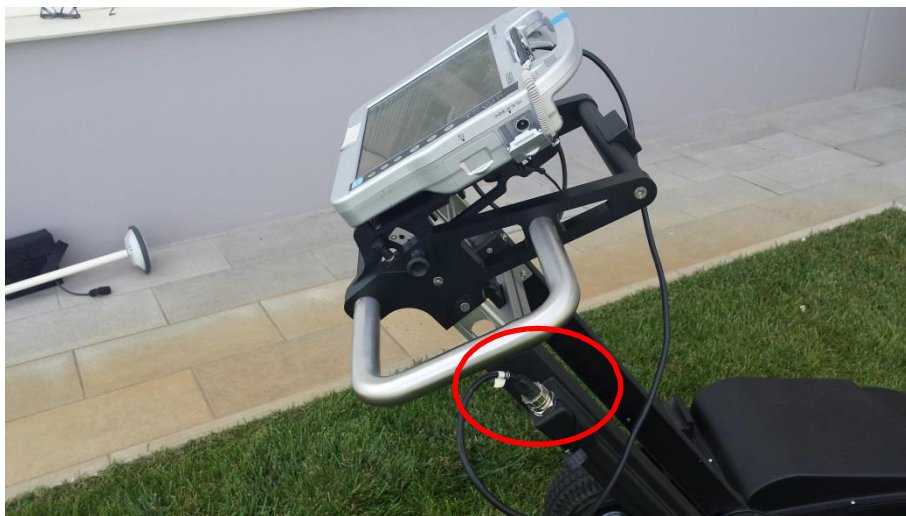
图33•通过LAN电缆连接笔记本电脑（红色圆圈）图
