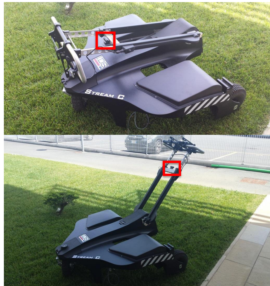
图22-通过按钮将Stream C 展开到红色正方形
