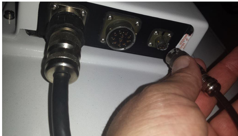
图29•将车轮电缆连接到DAD
