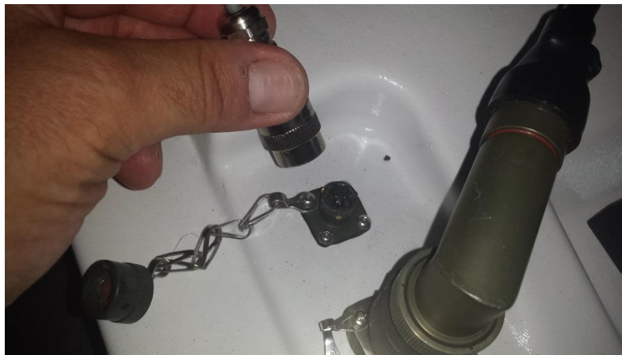
图30•将第二根电源线连接到天线
