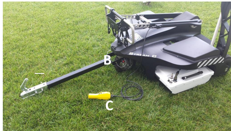
图36-安装牵引系统
