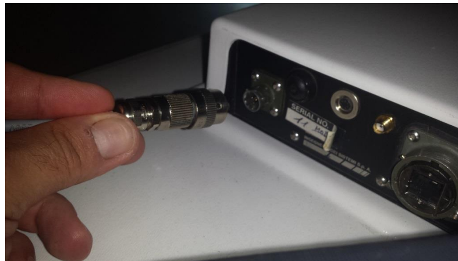
图26•连接电池电缆
