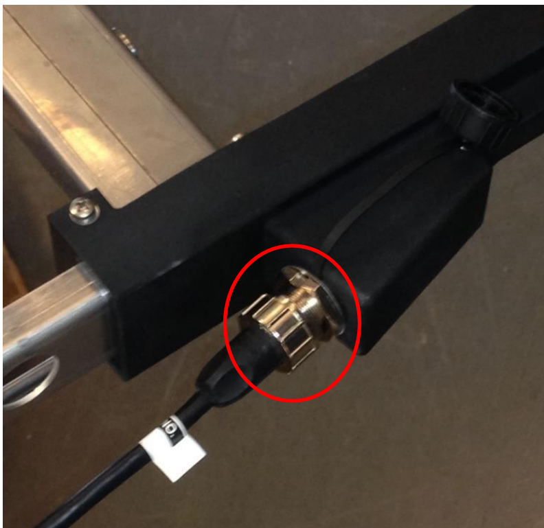
图8•手柄上的以太网电缆插头（红色圆圈）
