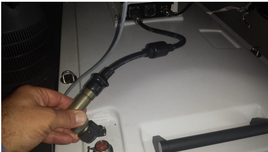
图28•连接天线电缆
