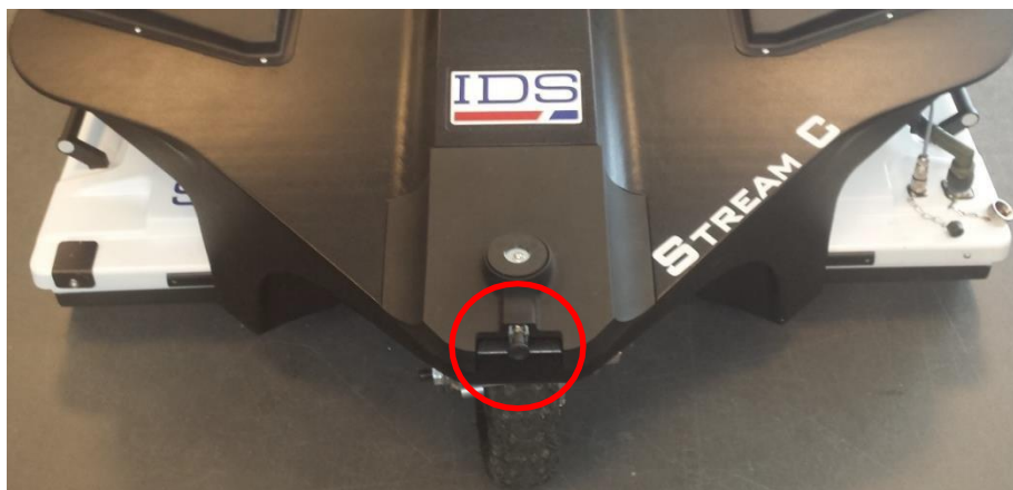
图10-旋转轮挡齿轮（红色圆圈）
