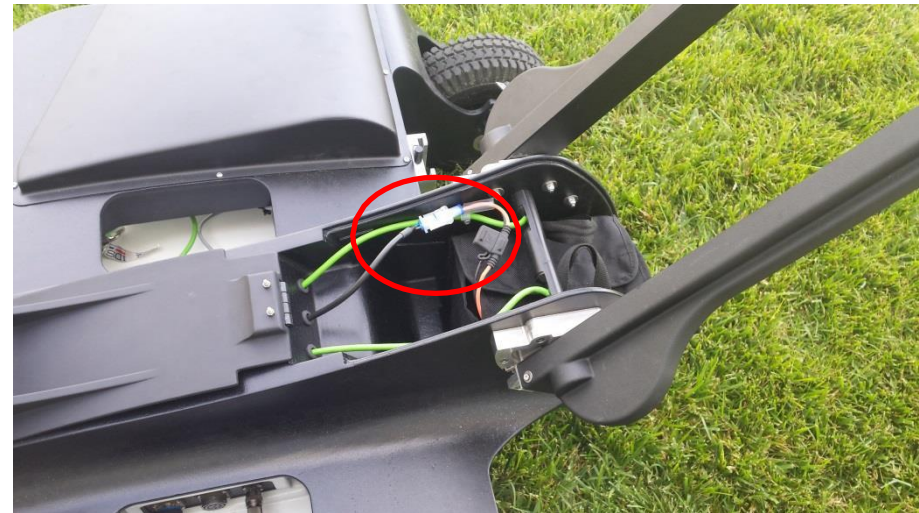
图32-连接主电池（男/女连接器位于红色圆圈中）
