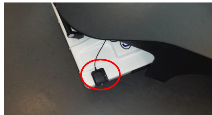
图39-金属板上的PPS天线
