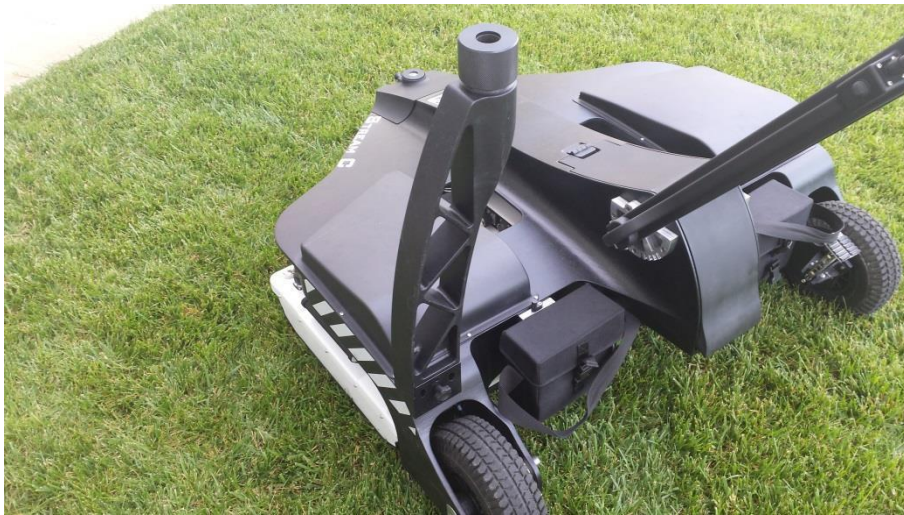
图37-安装GPS杆支撑
